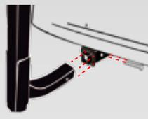
LA REJILLA SE INCLINA HACIA ATRÁS PARA FACILITAR ACCESO A LA PUERTA DE ELEVACIÓN
