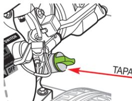
**Sensor de Aceite:** Para evitar el daño al motor causados por una cantidad insuficiente de aceite en el cárter, el motor está equipado con un sensor de bajo nivel de aceite. Si el aceite está por debajo de la cantidad segura, el sensor se activará y evitar que el motor arranque o se detenga el motor en marcha.
