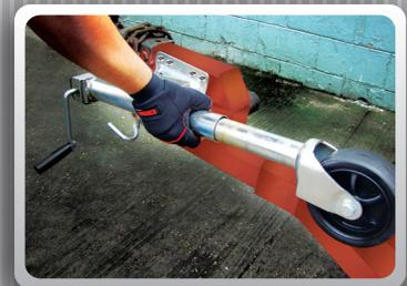
Una vez que el remolque ha sido acoplado en la bola de arrastre, regrese el pistón del gato con la cremallera.
