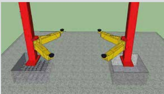
Los cimientos se conforman por dos bloques de concreto armado de 1m de ancho x 1 m de largo. (El piso debe estar a nivel)
