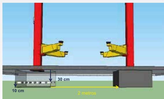
La profundidad de cada bloque de concreto será de 40 cm, es decir de 30 cm de concreto, después una cama de varilla armada de 3/8» o 1/2», 10 cm más de concreto para evitar que la varilla toque la tierra y se oxide perdiendo resistencia.
